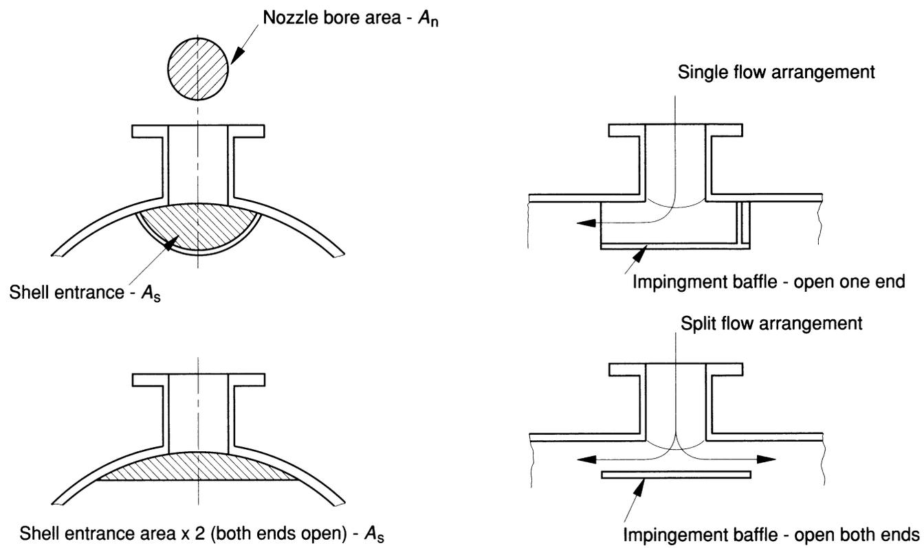
Figure 11 — Impingement baffles
