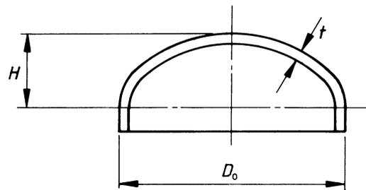
(b) Semi-ellipsoidal end
