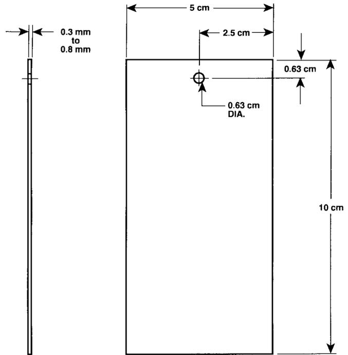
NOTE: ALL SHARP EDGES SHOULD BE BROKEN AND DEBURRED.
